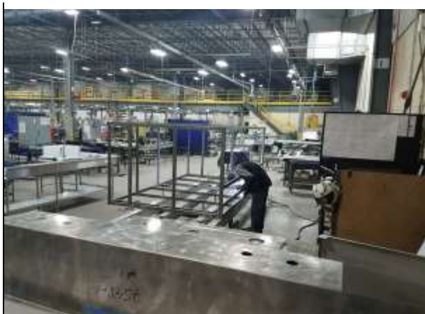
Soldando la estructura usando proceso Tig.
