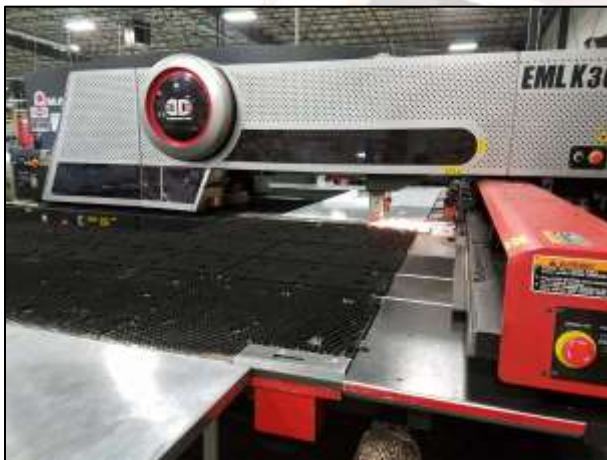
Láser cortando hoja de acero inoxidable.
