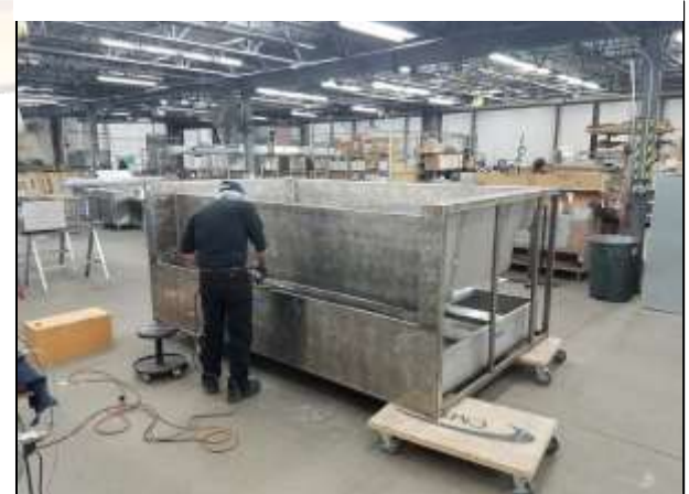
Puliendo la superficie del metal.
